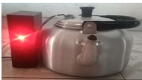
Gambar 11. LED Indikator Merah Kondisi Air di Teko Sudah Habis
