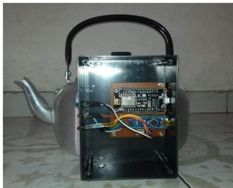
Gambar 8. Teko Air yang Sudah Terpasang Mikrokontroler
