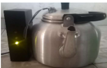
Gambar 9. LED Indikator Hijau Kondisi Air di Teko Masih Penuh
