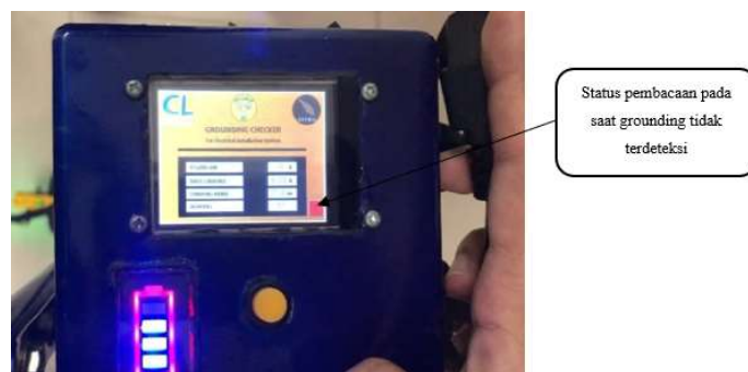
Gambar 6. Tampilan indikator tidak terdeteksi grounding .
