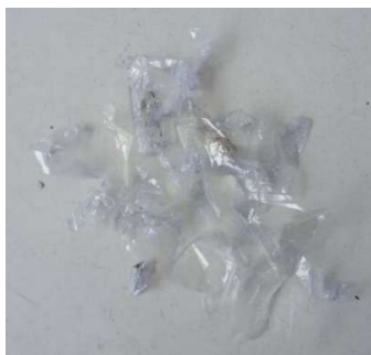
Gambar 13. Hasil Pengujian Pencacahan Plastik PET
