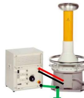
**Gambar 4.** Tranformator Tegangan Tinggi
