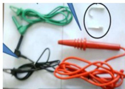
Gambar 9. Kabel Uji Tahanan Isolasi
