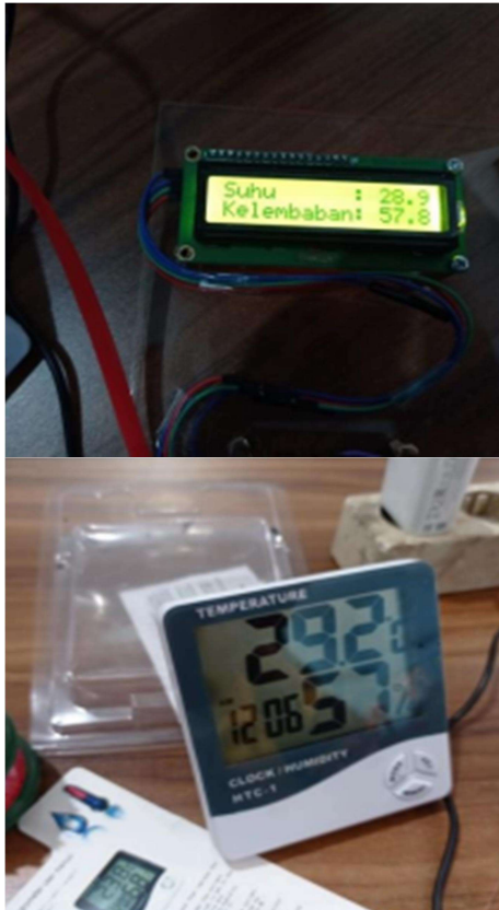
Gambar 8. Perbandingan hasil pengukuran sensor DHT22 dengan Hygro Thermometer
