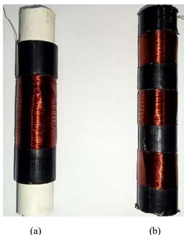
Gambar 3. Selongsong tabung (a) dengan kumparan tunggal dan (b) dengan tiga kumparan yang terhubung seri.
